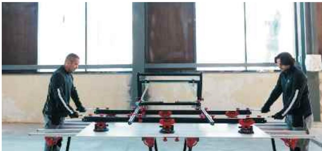
一些岩板柔性大，易弯曲变形，而且岩板的规格较大，因此切好的岩板从机台上拿下时要注意正确的方法。岩板如果可以用人从机台上拿下来尽量用人拿，少用吊夹，尤其是切了口的岩板，如果用吊夹吊，力度控制不好，或吊装过程中的左右晃动，很容易使岩板从切口处裂开。
